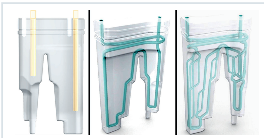
Bild 2. Das Design des Kühlsystems im Formeinsatz mit (v.l.n.r.) zwei Kupferstiften, einem konturfolgenden Kühlkanal oder einer blutgefäßähnlichen Kanalstruktur [13] © Montanuniversität Leoben
